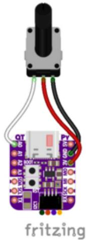
Potentiometer left pin (white wire) to QT Py ESP32-S2 A0
